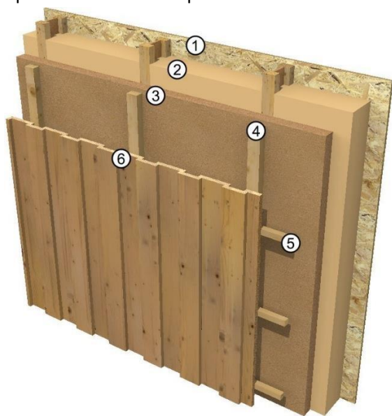
Izolacijski material brez fasadne obloge pod opažem od tal do stropa
